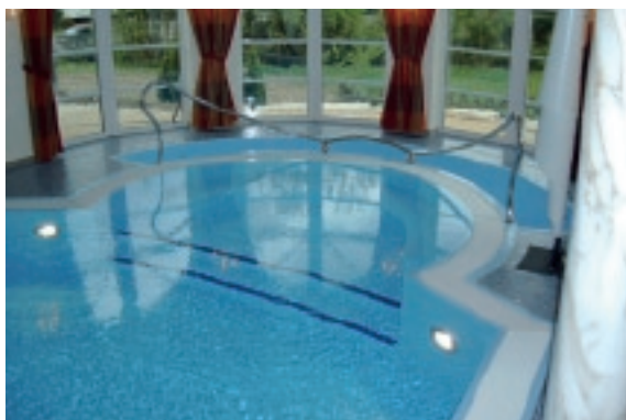
Freiform-Solebecken mit Überlaufrinne, Luftsprudelbank und angebundenem Kneippbecken. Komplette freitragend.
